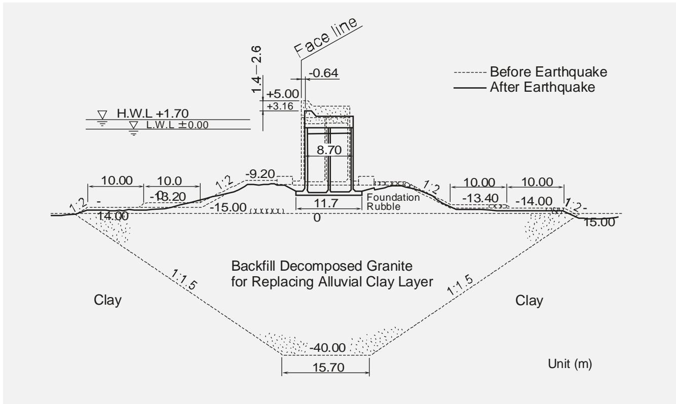
防波堤が沈下し、それに伴って左右にはらみだす捨石マウンドの変形が解析されます。
