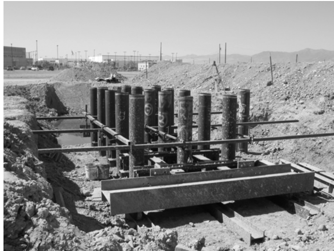
図 3-10-1-4 実物大群杭載荷試験場所の地下水位の状況 1)
