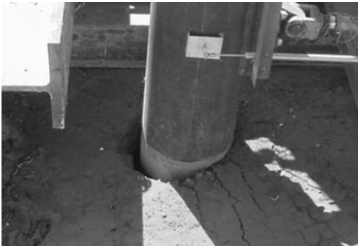
図3-5-58 地盤-杭の剥離の発生状況（ブリガムヤング大学による実物大現地実験より） （上の写真において、杭が右方向に押され、杭の左側に空隙が発生している）
