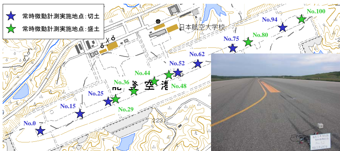
図 3-10-2-5 滑走路での常時微動計測位置と計測状況
